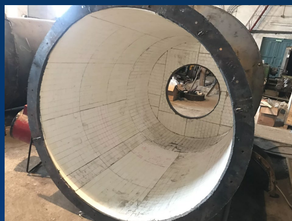
Футеровка высокотемпературного циклона.
