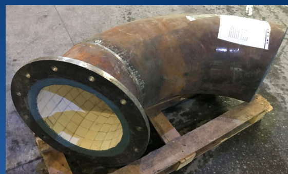
Футеровка высокотемпературного циклона.
